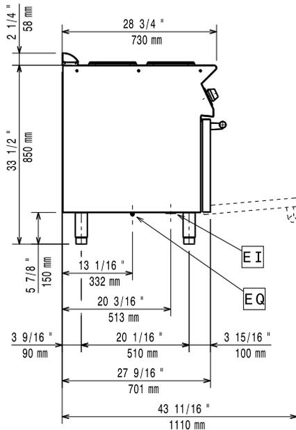
EI = Conexión eléctrica (energía)
